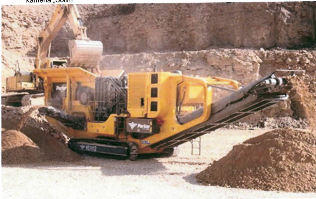
Slika 7.1. Primarno sitnjenje i klasiranje na pokretnom postrojenju Parker, na kamenolomu tehničkog kamena „Solim“
